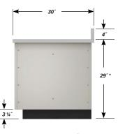
\* HEIGHT SHOWN IS BASED ON A 11/4" THICK WORK SURFACE. OVERALL HEIGHT VARIES DEPENDING ON THICKNESS.
