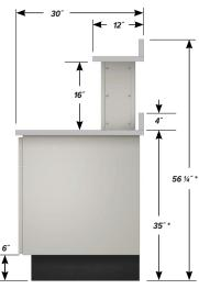
\* HEIGHT SHOWN IS BASED ON A 1 1/4" THICK WORK SURFACE
